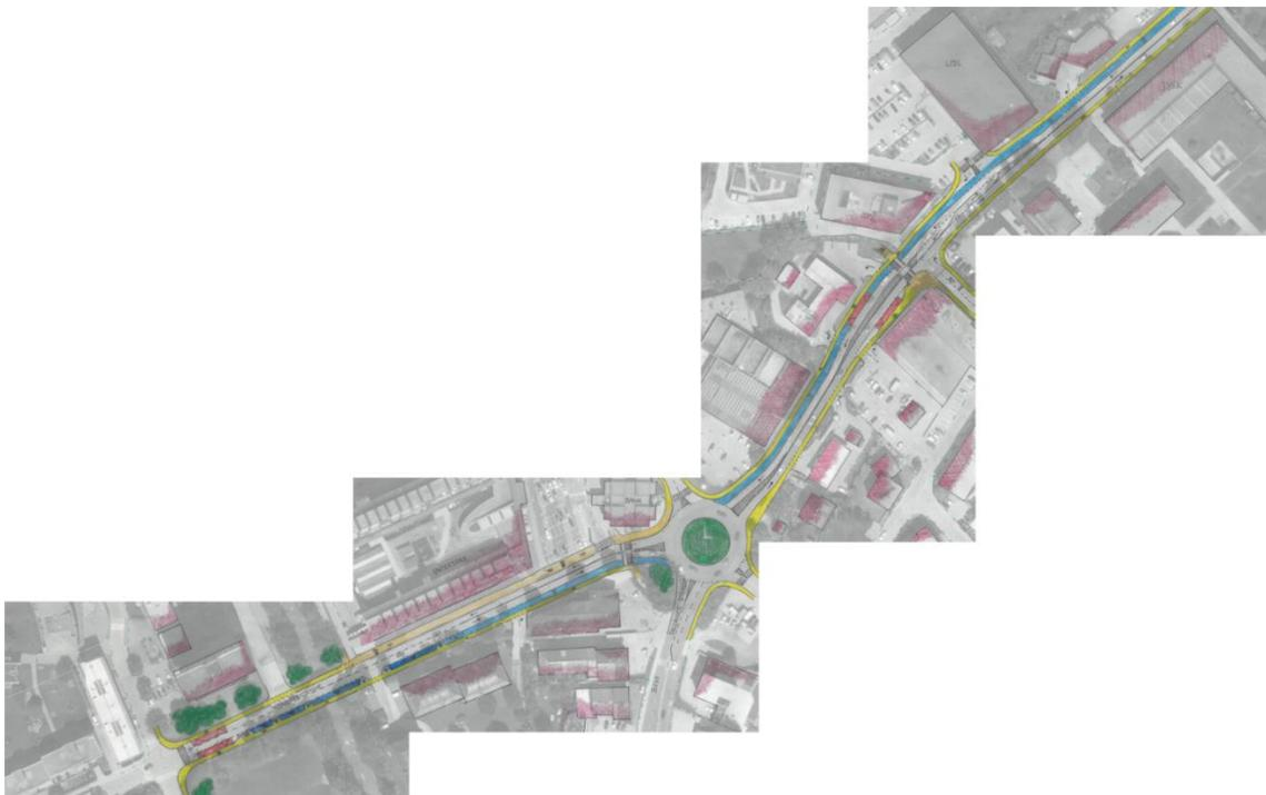
Abbildung 3-9: Busspur in Seitenlage, Teil 2
