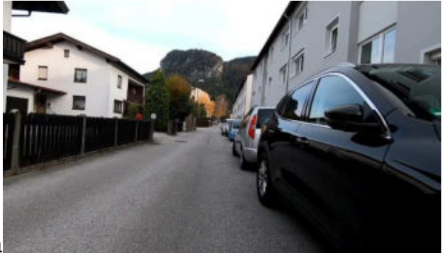
4: Die Einbahn kann gegen die Fahrtrichtung nicht mit einem Mehrzweckstreifen markiert werden, da die Fahrbahn zu schmal ist. In Erwägung zu ziehen ist es z.B. eine Fahrradstraße einzurichten
